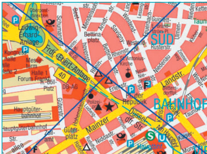
Bild 6: Lageplan einer praktisch durchgeführten Schallquellenortung. Der Kreuzungspunkt der beiden eingetragenen Peilstrahlen ist der Ort der gesuchten Geräuschquelle.
